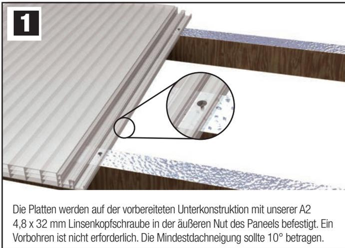
Die Platten werden auf der vorbereiteten Unterkonstruktion mit unserer A2 4,8 x 32 mm Linsenkopfschraube in der äußeren Nut des Paneels befestigt. Ein Vorbohren ist nicht erforderlich. Die Mindestdachneigung sollte 10° betragen.
