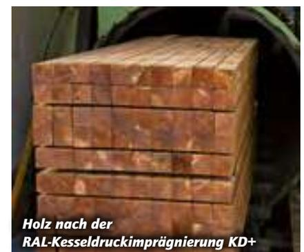
Holz nach der RAL-Kesseldruckimprägnierung KD+
