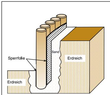
Palisaden sollten nicht mit Farbe oder Lasur gestrichen werden, da sich dann Feuchtigkeit unter der Oberfläche staut und zu Fäulnis führen kann. Das Holz muss „atmen“ können!
