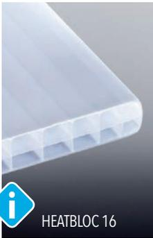
Bei besonderen Anforderungen zur Hitze-reduzierung empfehlen wir Ihnen unsere HEATBLOC Stegdreifachplatte 16 mm (Preisliste S. 12). Hohe Steifigkeit, gute Wärmedämmung und ein zusätzlicher Bonuspunkt machen diese Platte unverwechselbar: Die auf der Wetterseite aufgebraute Infrarot-Reflektionsschicht reduziert die Sonneneinstrahlung um 45%. HEATBLOC – auch ohne zusätzliche Beschattung behalten Sie immer einen kühlen Kopf.
