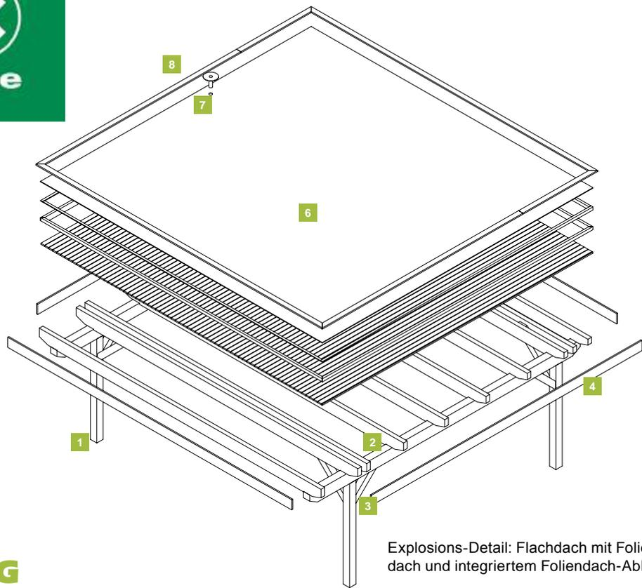
Explosions-Detail: Flachdach mit Foliendach und integriertem Foliendach-Ablauf
