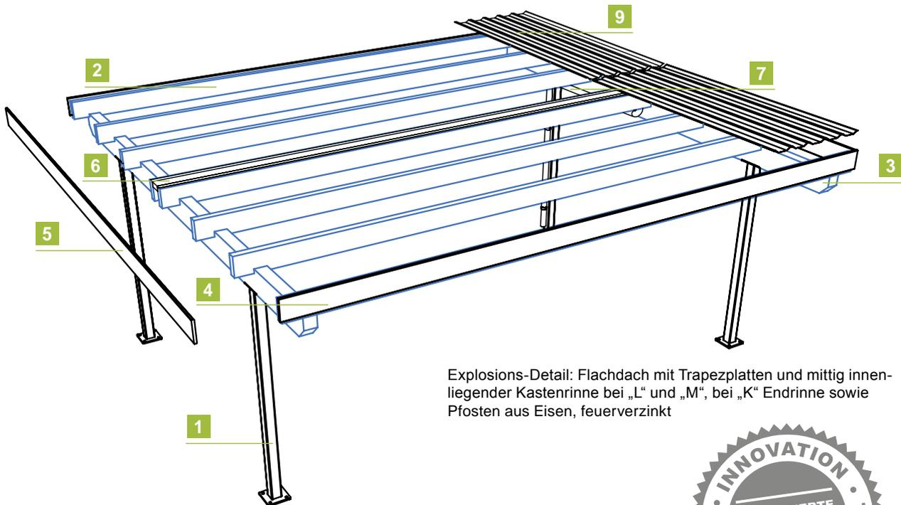
Explosions-Detail: Flachdach mit Trapezplatten und mittig innenliegender Kastenrinne bei „L“ und „M“, bei „K“ Endrinne sowie Pfosten aus Eisen, feuerverzinkt
