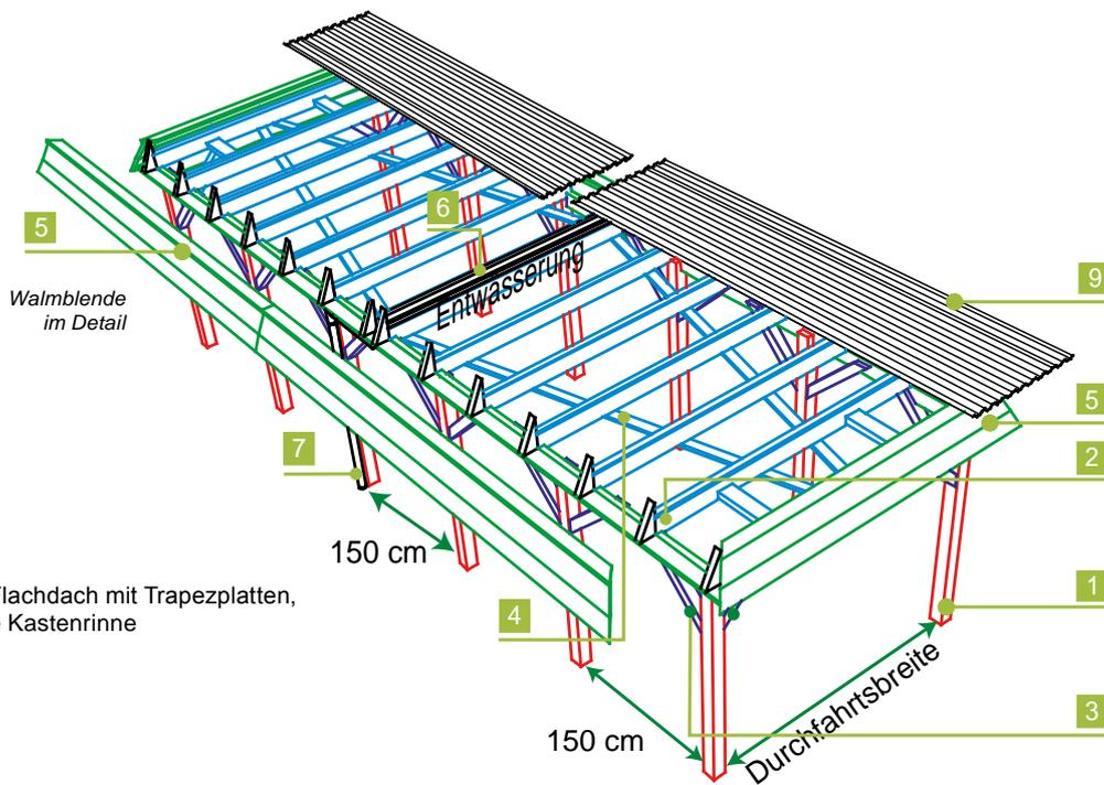
Explosions-Detail: Flachdach mit Trapezplatten, mittig innenliegende Kastenrinne
