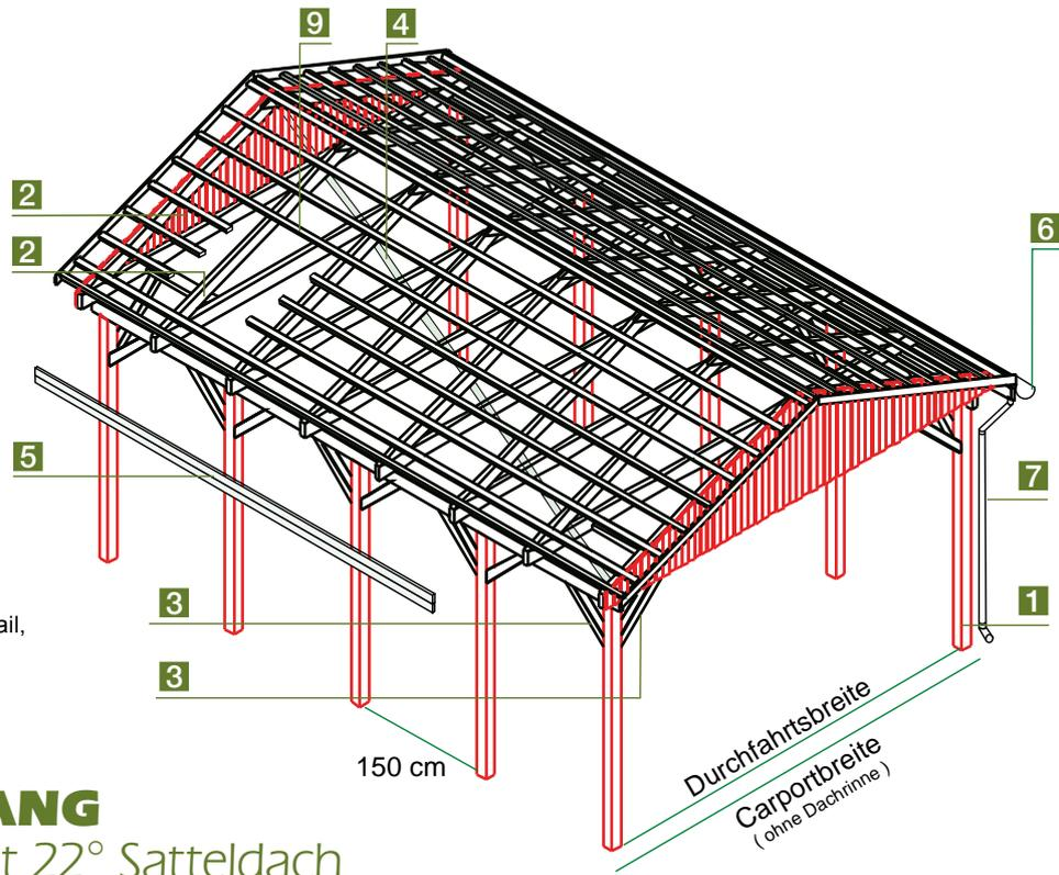
Konstruktion im Explosions-Detail, gilt für 22°-Dachneigung
