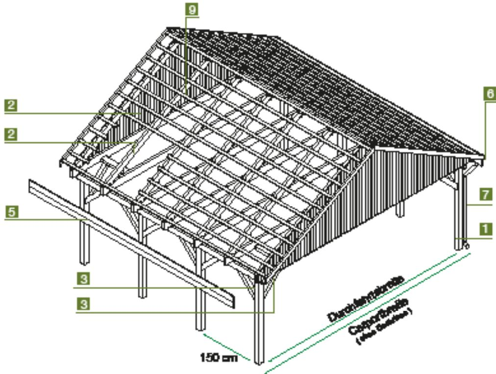
Konstruktion im Explosion gilt für 30°-Dachneigung
