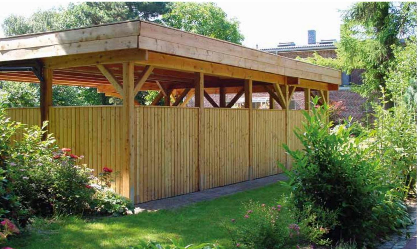
Wände fertigt Joda® in verschiedenen Höhen - hier eine halboffene Lösung aus Classic KDI. Standard: gefügte Verbretterung aus Rundkantenprofilen
