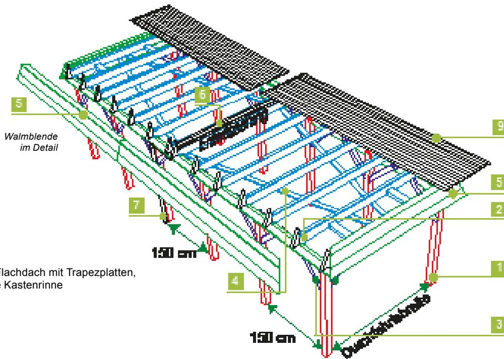
Explosions-Detail: Flachdach mit Trapezplatten, mittig innenliegende Kastenrinne
