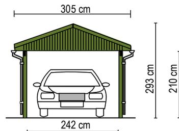
Modell „Wedel M (D), Natur“ mit Geräteraum Typ 01. Abb. zeigt Gestaltungsbeispiel mit ausgemauertem Fachwerk und Querkopfbändern.
