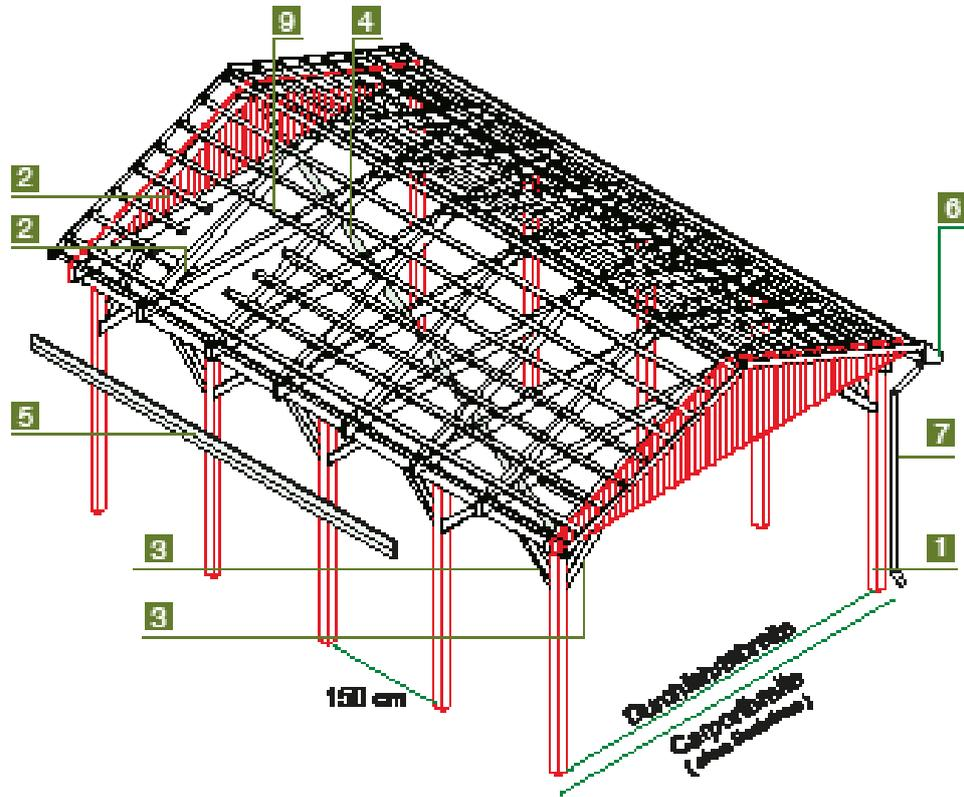
Konstruktion im Explosions-Dei- gilt für 22°-Dachneigung
