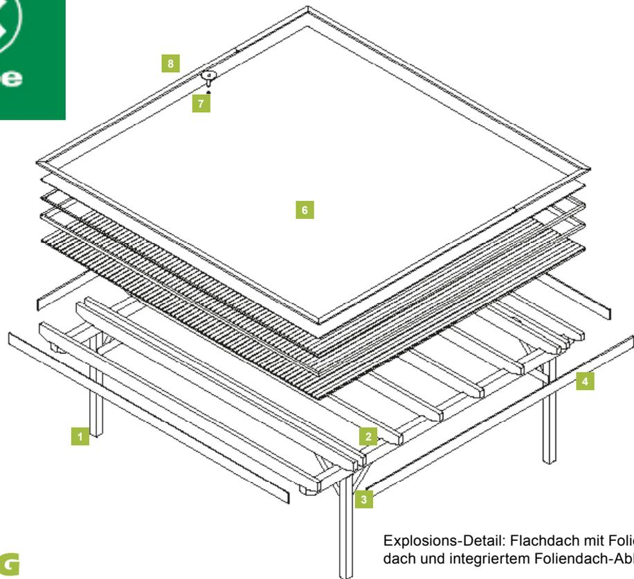
Explosions-Detail: Flachdach mit Foliendach und integriertem Foliendach-Ablauf
