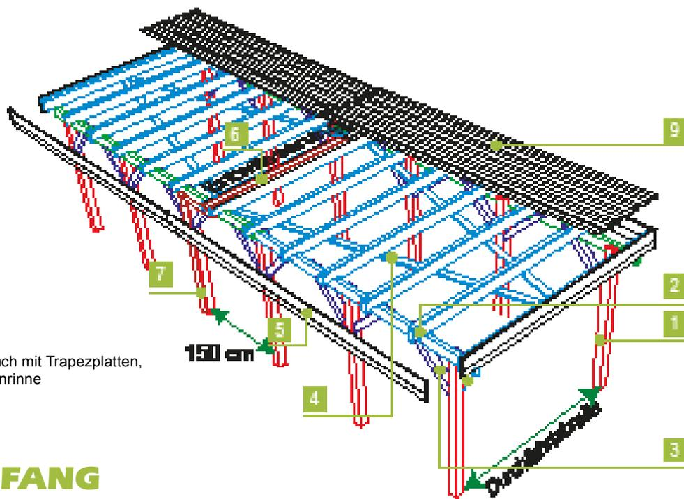
Explosions-Detail: Flachdach mit Trapezplatten,
