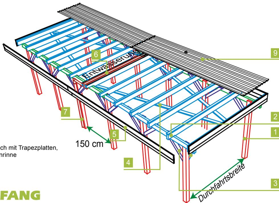
Explosions-Detail: Flachdach mit Trapezplatten,
