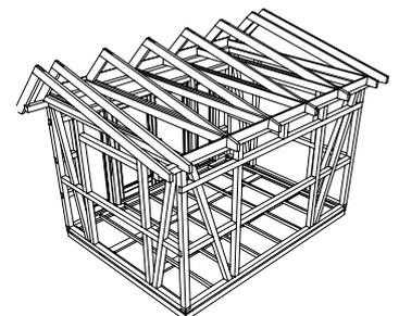
Grundkonstruktion 4 x 3 m
