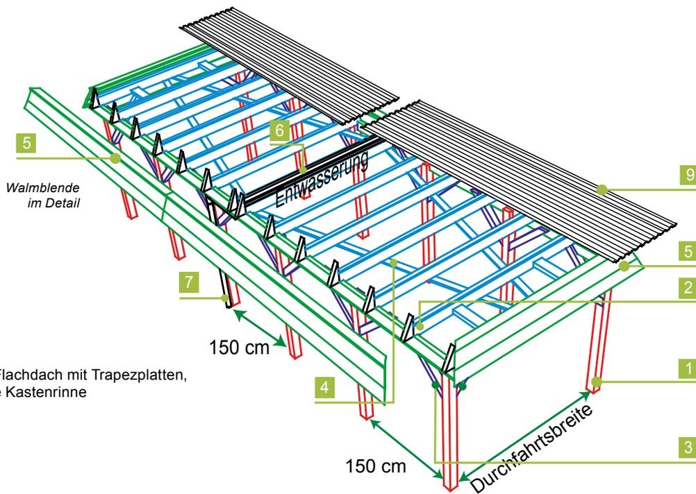
Explosions-Detail: Flachdach mit Trapezplatten, mittig innenliegende Kastenrinne
