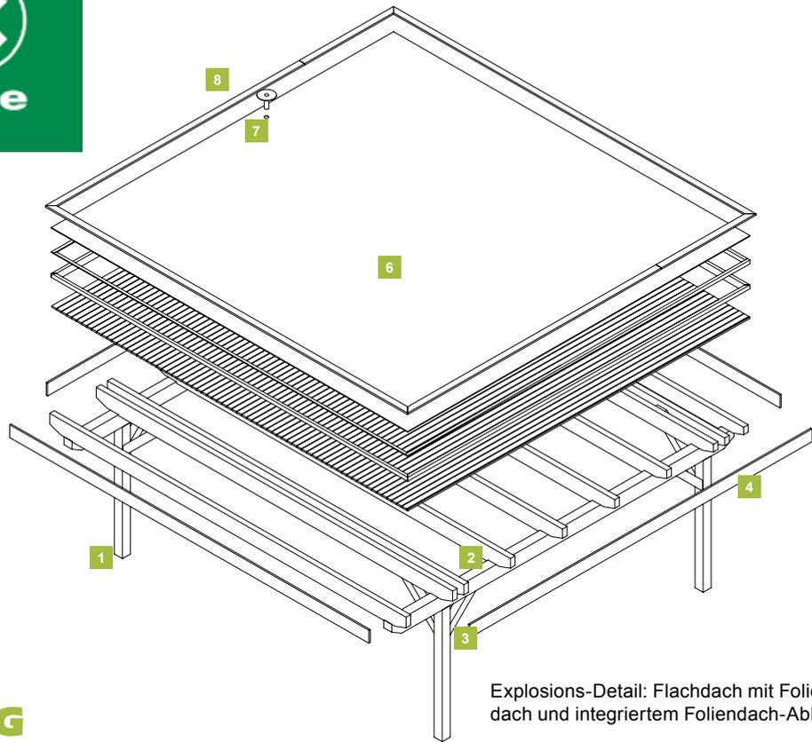
Explosions-Detail: Flachdach mit Foliendach und integriertem Foliendach-Ablauf
