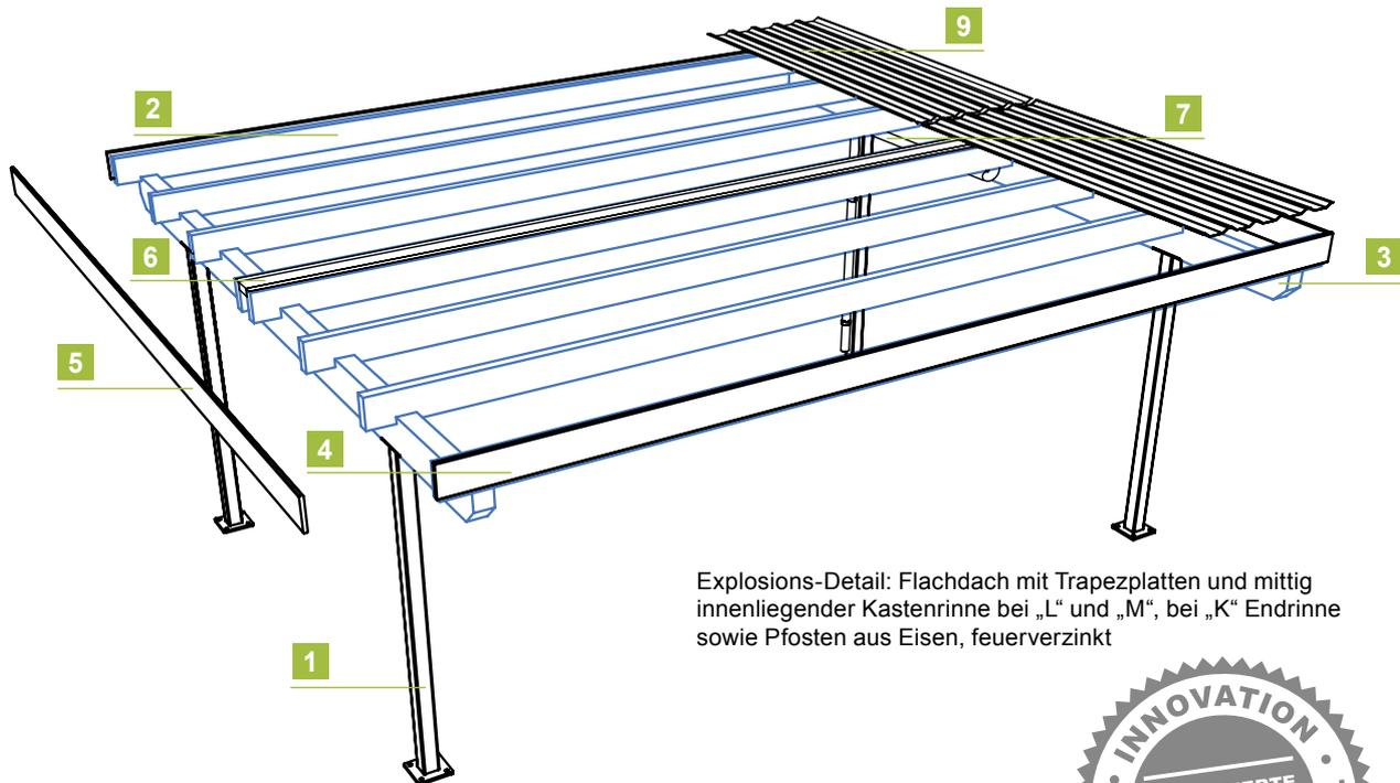
Explosions-Detail: Flachdach mit Trapezplatten und mittig innenliegender Kastenrinne bei „L“ und „M“, bei „K“ an der Rückseite sowie Pfosten aus Eisen, feuerverzinkt
