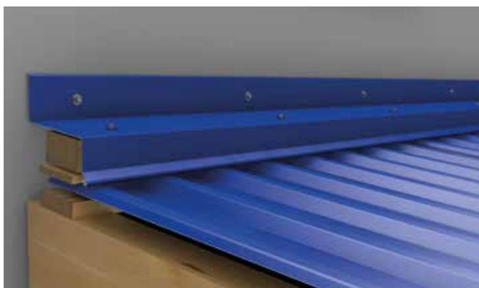
Die Befestigung der Anschlussleiste wird sowohl bei einem längslaufenden Anschluss wie auch bei einem querlaufenden Anschluss auf dem Wellenberg vorgenommen. Lassen Sie stets den langen Schenkel auf das Dach decken. Auch hier wird die Blech-auf-Blechbefestigung mittels einer A2 Edelstahlschraube vorgenommen. Die Befestigung der
