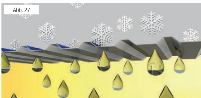
Ohne Vlies: Kondenswasser tropft ab
