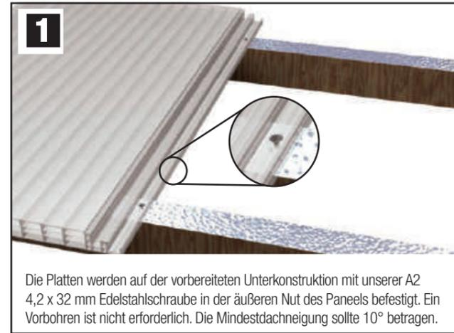
Die Platten werden auf der vorbereiteten Unterkonstruktion mit unserer A2 4,2 x 32 mm Edelstahlschraube in der äußeren Nut des Paneels befestigt. Ein Vorbohren ist nicht erforderlich. Die Minstdachneigung sollte 10° betragen.
