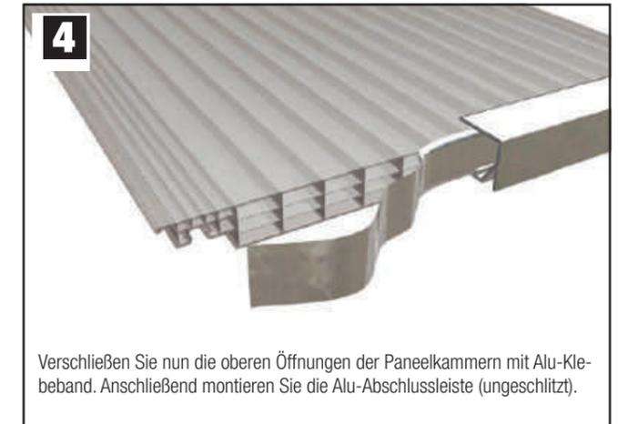
Verschließen Sie nun die oberen Öffnungen der Paneelkammern mit Alu-Klebeband. Anschließend montieren Sie die Alu-Abschlussleiste (ungeschlitzt).
