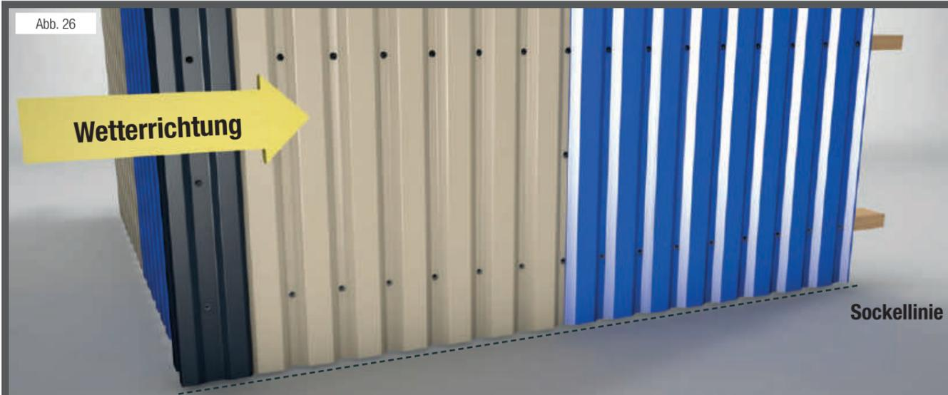
Die Platten müssen winklig an der Sockellinie ausgerichtet werden. Bei einer leicht schrägen Wand müssen ggf. überstehende Teile abgeschnitten werden.
