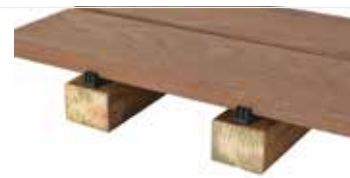
Terrassengleiter / Abstandshalter (Hier an Sollbruchstelle gekürzt für Anfangsdiele)
