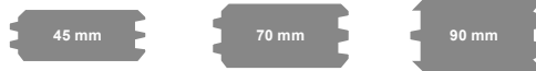
Blockbohlen 45 x 121 mm, 70 x 146 mm (mit Doppel-Nut und -Feder), 90 x 146 mm (mit Dreifach-Nut und -Feder), 4-seitig gefast
