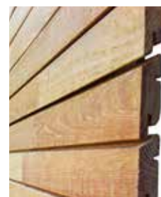
Rhombusprofil TIGA mit Nut und Feder 21 x 80 mm (Robinie & Eiche) 26 x 90 mm (Thermokiefer)
