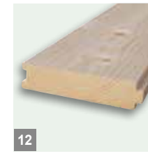
Spundbohlen bis 120 mm Stärke, mit Nut und Feder
