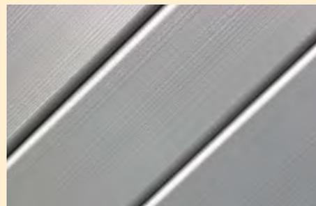
Die ebene Oberflächenstruktur der Tanne ermöglicht eine glatte und deckende Oberflächenbeschichtung.
