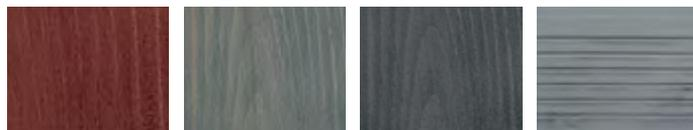
Bei den Farbtönen **Schwedenrot**, **Basaltgrau** und **Lavagrau** wird eine stärkere Anfärbung gewünscht. Die ursprüngliche Holzfarbe wird fast vollständig abgedeckt. Ein Teil der Holzstruktur wie Maserung und Äste bleiben aber sichtbar.
