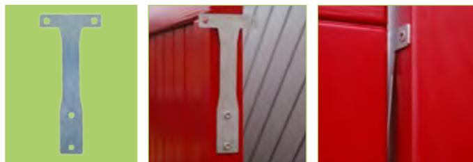
Elementhalter aus Edelstahl (gebrauchsmustergeschützt). Dezentere Befestigung, fallen erst bei genauem Hinsehen auf. Nur für Elemente mit umlaufenden oder seitlichen Rahmen von mindestens 35 mm Stärke geeignet. Flexibel, d.h. kleine Differenzen im Pfostenabstand werden ausgeglichen.
