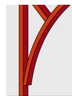
Länge und Radius des Leimholzbogens sind immer gleich. Bei Überschreiten der Carport-Standardhöhe wird der Leimholzbogen angehoben und kann optional mit einem Passstück verlängert werden.
