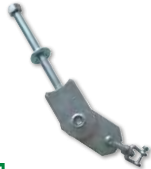
23 24 Schwinghaken verzinkt, mit Kugellager in einer 10 mm dicken Stahlplatte. Nylonlager (außen Ø 15 mm, innen Ø 6 mm) für die Befestigung von Ketten, Gesamtlänge 120 mm/160 mm, Gewindestange mit M14-Sicherheitsmutter, Schäkel mitgeliefert.
