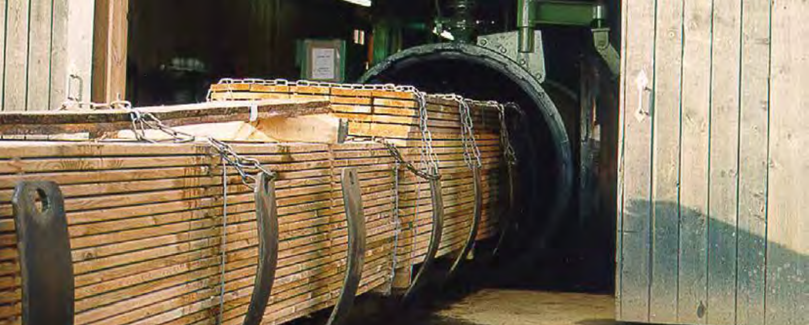
Loren mit Gartenholz – Beladen der Kesseldruckanlage
